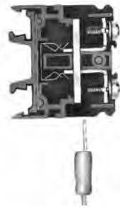
(1) 螺丝为完全上升的状态，圆形压接端子可直接插入。
